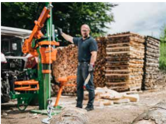
Treuil « 500 » avec crochet forestier de série, câble de 20 m et puissance de traction de 500 kg. Pour les HydroCombi 16, 18 et 20. Article n° HC
