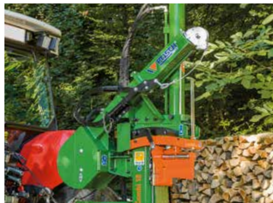
Avec le treuil « 750 » et le mandrin de série avec un câble de 40 m et une puissance de traction de 750 kg, la vitesse d'évacuation est illimitée (icône). Pour les HydroCombi 16, 18, 20, 22, 24 et 26. Article n° HW
