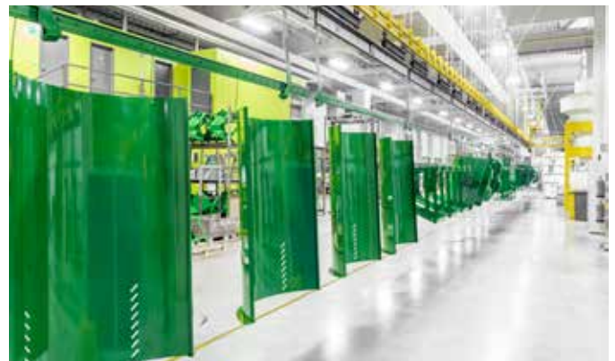
Le hall de production avec installation de revêtement par poudrage moderne protège chaque pièce de la machine pour longtemps.
