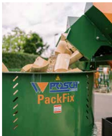
Le tambour PackFix est rempli d'un stère de bois par le tapis d'évacuation.
