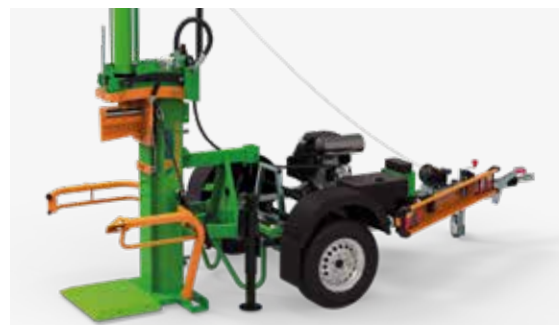
Das Straßenfahrwerk ermöglicht, dass der HydroCombi fahrbar auf Achse ist. Das Fahrwerk ist demontierbar, damit die Maschine auch mit Dreipunktaufhängung transportiert werden kann. Artikel-Nr. SA
