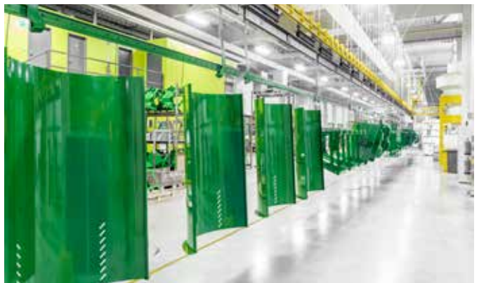
Die Produktionshalle mit moderner Pulverbeschichtungsanlage bringt einen langlebigen Schutz für jedes einzelne Maschinenteil.
