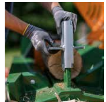
Oscar: Das optionale 4-fach-Wendespalkkreuz kann beidseitig für verschiedene Holzdurchmesser verwendet werden.
