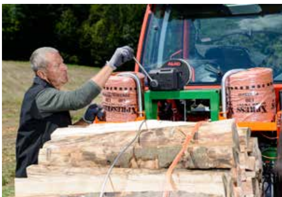
Mithilfe der Seilwinde wird das Holzbündel vorgespannt.
