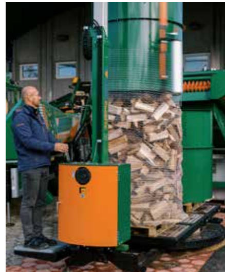
Die Trommel selbst dreht sich nicht mit und wird hydraulisch nach oben gezogen.
