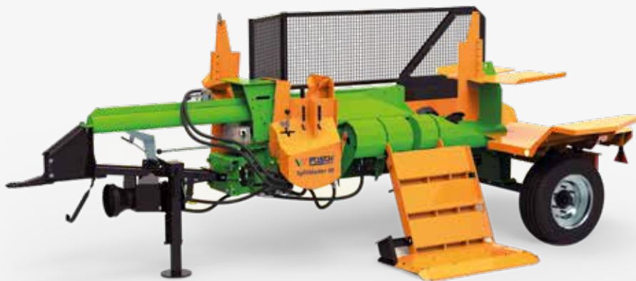
SplitMaster 30 PZG auf Längsfahrwerk in Arbeitsstellung
