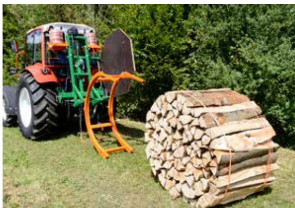
Das fertig verschnürte Bündel kann komfortabel aus der Bündelvorrichtung gerollt werden.
