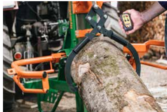
Die Seilwinde mit optionaler Greifzange und Funkfernbedienung für den leichten Transport schwerer Stämme.
