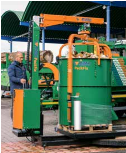
Der Rotationsarm umwickelt die Befülltrommel und die Scheite sicher mit dem Rundballnetz.
