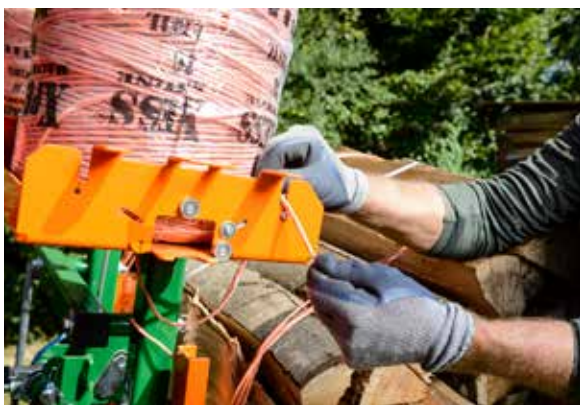
Als letzter Arbeitsschritt wird das Garn verknotet und mit der integrierten Schneidvorrichtung abgetrennt.
