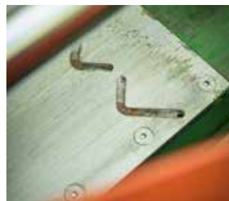
Integrierte Schmiervorrichtung über Handpumpe (optional erhältlich)
