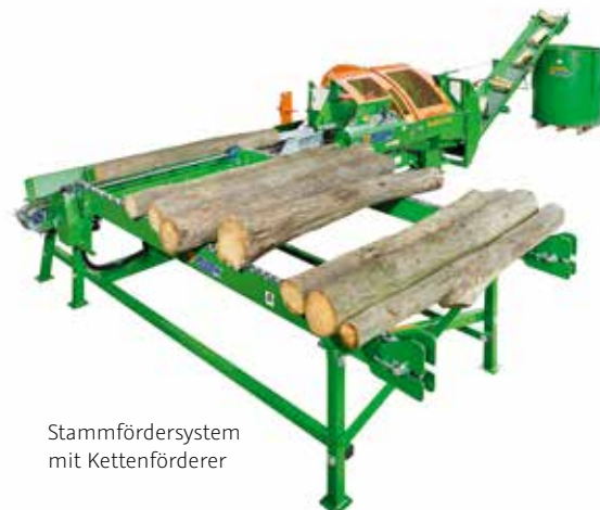
Stetige Versorgung mit dem Stammfördersystem, bestehend aus 1 Querförderer und 2 Längsförderer.
