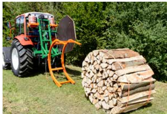
Das fertig verschnürte Bündel kann komfortabel aus der Bündelvorrichtung gerollt werden.
