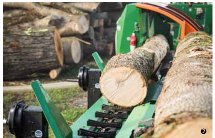
Stetige Versorgung mit dem Stammfördersystem, bestehend aus 1 Querförderer und 2 Längsförderer.
