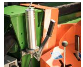
Integrierte Schmiervorrichtung über Handpumpe (optional erhältlich)
