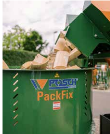
Die PackFix-Trommel wird über ein Förderband mit einem Raummeter Scheitholz befüllt.
