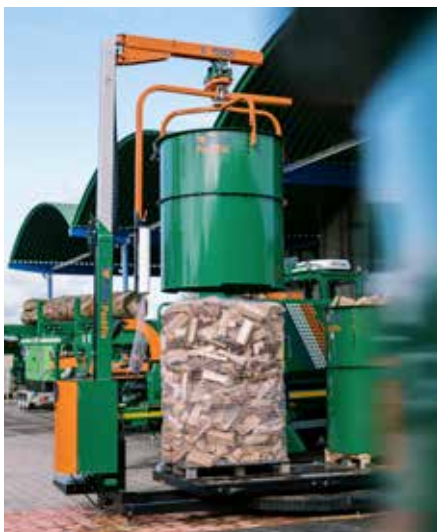
Ist die Befüll-Trommel vollständig nach oben gezogen, wird das Netz abgetrennt und das Holzpack abtransportiert.
