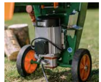
Der starke 5,5-kW-E-Motor im Detail. Zu sehen ist auch die Parkvorrichtung des Spaltmessers auf der Rückseite.
