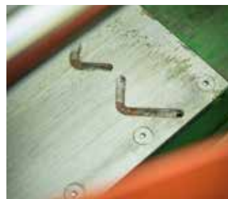
Integrierte Schmiervorrichtung über Handpumpe (optional erhältlich)
