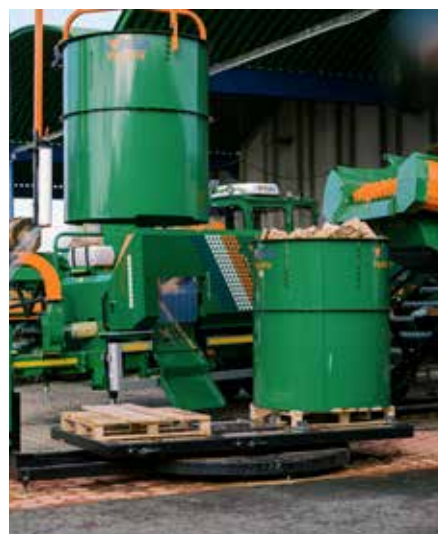
Der Schwenktisch spart durch die gleichzeitige Befüllung und Verpackung viel Zeit.
