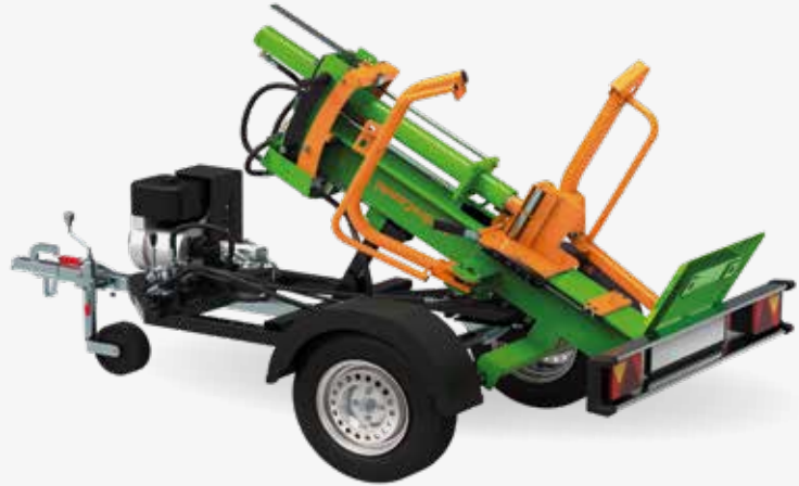
HydroCombi 13 Fahrwerk B5,5 D-V2, Transportstellung
