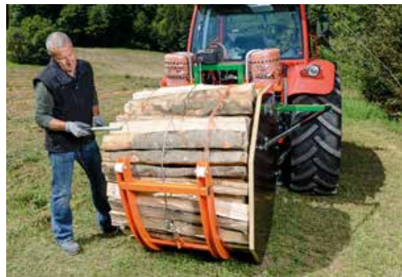
Das Pressgarn wird über das Holzbündel gewickelt.
