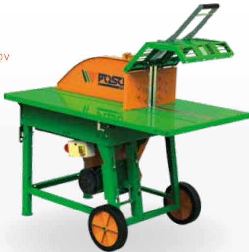
Rolltischsäge ES,5 mit Brennholzschnitt-Ausrüstung
