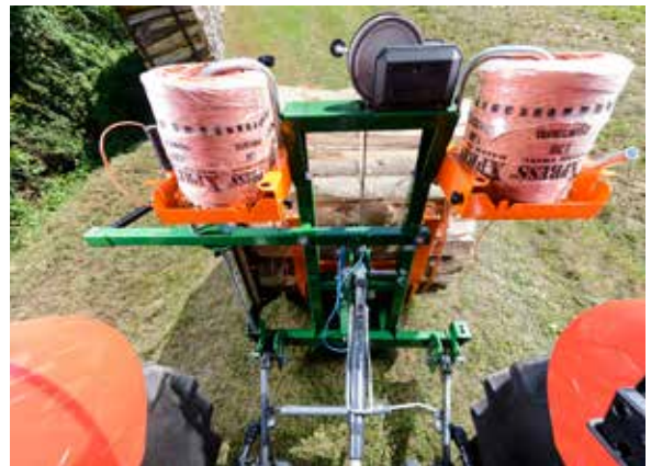
Bündelvorrichtung mit Pressgarnschnur ist einfach zu handhaben und unproblematisch in der Entsorgung.
